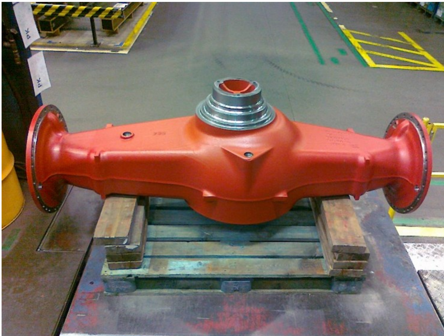
Figur 36. Axelkåpa till anläggningsmaskin, vikt 450 kg. Tillverkad i ferritiskt lösningshärdat segjärn EN-GJS-500-14.
